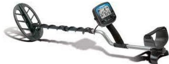
Текнетикс Омега 8000 - профессиональный грунтовый металлодетектор. Прибор использует цифровую процессорную обработку сигналов, поэтому обнаруживает цели даже на замусоренных участках. Глубина обнаружения: небольшие объекты на глубине до 26 см, крупные - до 110 см. Большой ЖК-дисплей позволяет получить информацию об обнаруженном металлическом предмете с отображением индекса электропроводности (VDI) объекта от 10 до 99.
